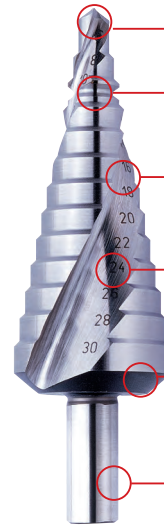
Kreuzanschliff Split Point Kantenbrecher Edge-Breaker Variable Spiralnute Variable spiral flute Laserskalierung Loch- \varnothing Hole-diameter laser engraved on the tool Laserskalierung Drehzahlen Rotation speed laser engraved Mit 3-Flächenschaft With 3-flats shaft
